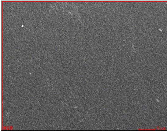
A) SEM - Fresh Unused Membrane
